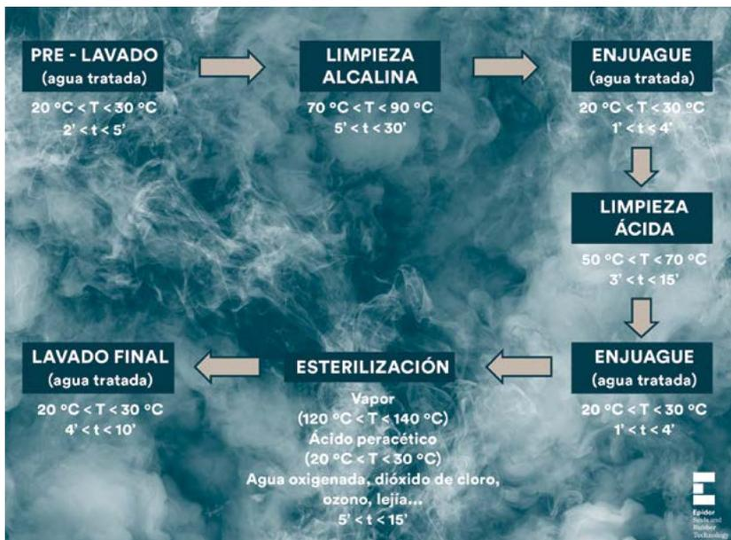
Una etapa CIP (*Cleaning In Place*) se caracteriza por su duración, por la temperatura, la elección de los agentes de limpieza y un flujo turbulento. La combinación de varias etapas CIP determinan el proceso de limpieza que finalizan en una etapa SIP (*Sterilization In Place*), la cual desinfecta las superficies tratadas y suele preceder al lavado final.
